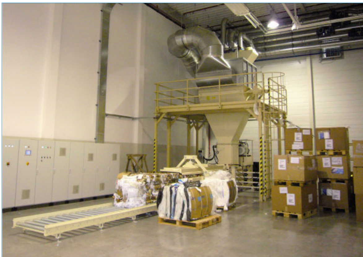
Separator ścinków z prasą belującą
